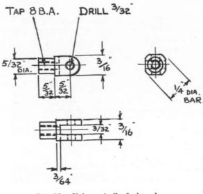
Fig. 81. Valve spindle fork-end.
